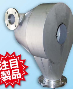
サイクロンの性能はそのままに、本体高さを低くしました。前面窓(取外し可能)から内部の視認性を確保、配管を取り外す事無く清掃が可能です。(特許取得済)
